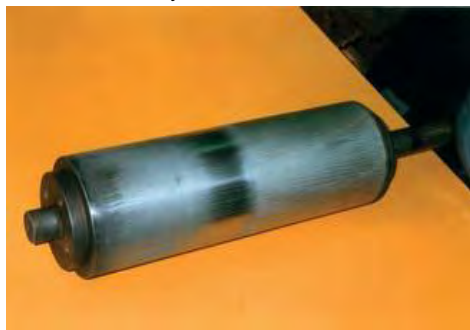
Kuva 14. Kappale joka pinnoitettiin CRAFT-projektin aikana kolmiarvoisessa kovakromauskylvyssä.
