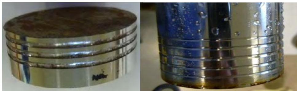
Kuva 17. Triplehard -kromausprosessilla ( Cr^{3+} ) pinnoitettuja koekappaleita pinnoitteen kiinnipysyvyysskokeen jälkeen. Testissä koneistettiin sorvilla kovakromipinnoitettua akselia. Pinnoitteen kiinnipysyvyys oli testin mukaan hyvä.
